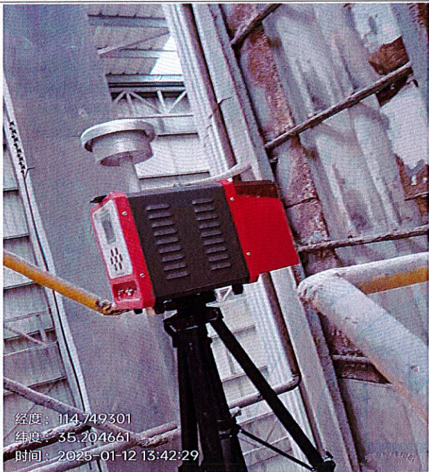
图 2-1 无组织检测 飞灰仓顶除尘风机 1 出口
